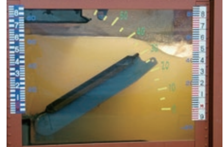
試験設備による排水試験
