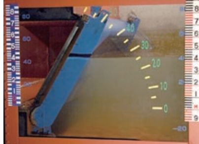
試験設備による止水試験
